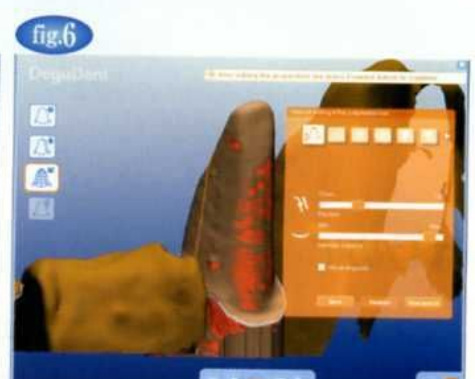
fig.6: 無理な補正によりマージンラインが波状に表示。
