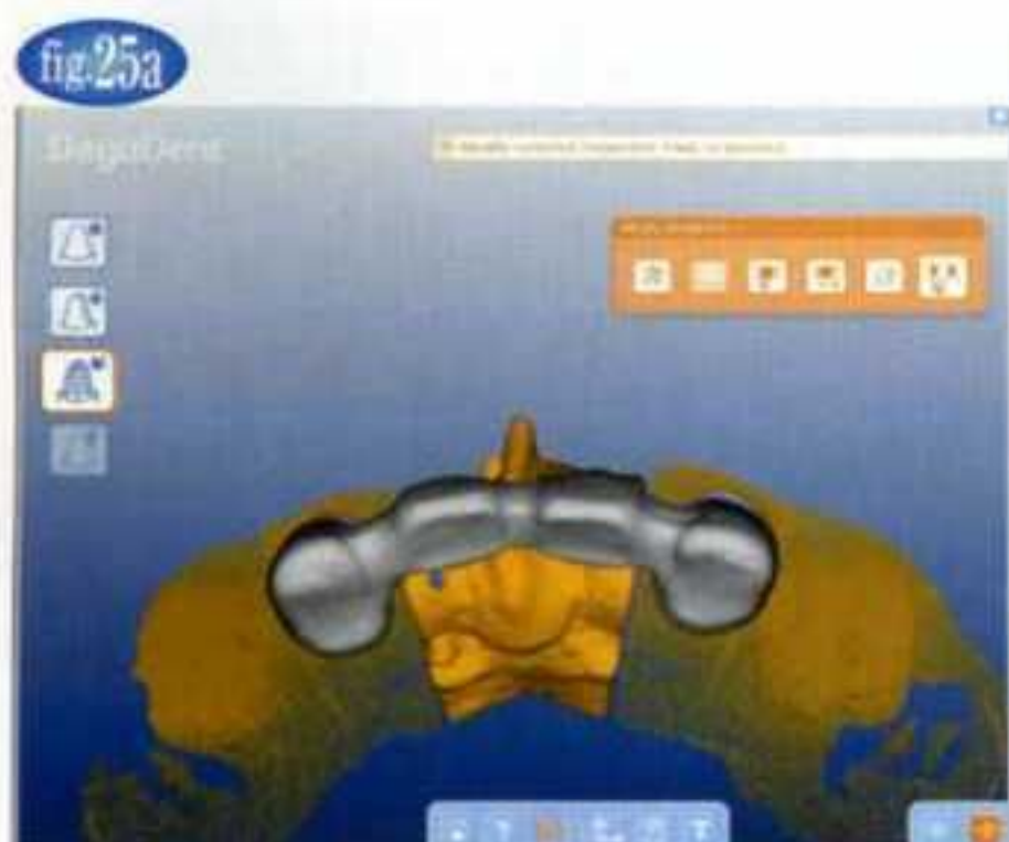
fig.25a : 強度確保のため、単純に連結太さは補足できない。
